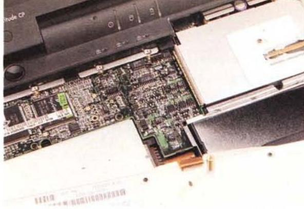
L'interno del portatile è particolarmente curato. In evidenza il dissipatore del Mobile Pentium: una barretta di rame convoglia il calore in eccesso verso un piccolo profilato di alluminio nel quale viene forzato il passaggio dell'aria con una ventolina.
